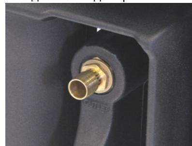
10. Наполнить оборудование водой, начиная с колонны 1, до тех пор, пока обе колонны не будут заполнены, и пока вода не будет выливаться из выходного отверстия.
