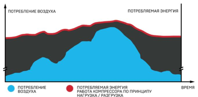
Данная технология позволяет поддерживать давление в системе сжатого воздуха с высокой точностью, достигая экономии **до 35%** по сравнению с компрессорами нагрузка/разгрузка.
