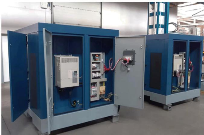
**ПОТОК НАГРЕТОГО ВОЗДУХА** дозируется перепускным дросселем с электроприводом и регулируется термостатом, что позволяет сохранять в отапливаемом помещении постоянную температуру, тем самым снизить затраты на отопление. В случае, если потребность в отоплении отсутствует, теплый воздух полностью выводится вне помещения.
