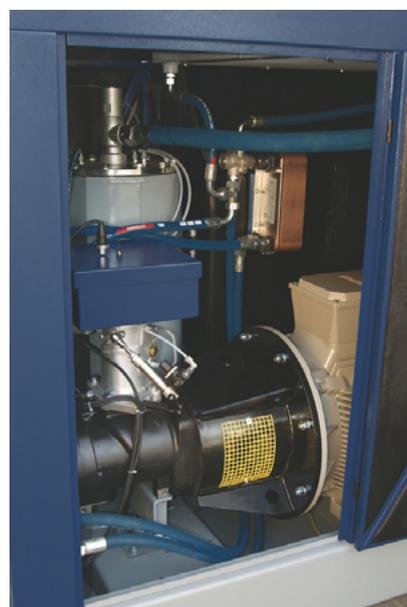
При номинальной производительности компрессора существует возможность подогрева воды до температуры примерно 60°C и выше.
