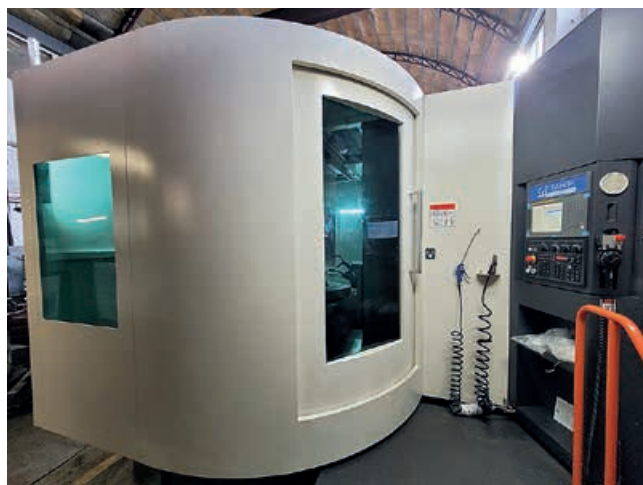
Запущены 2 фрезерно-расточных ЧПУ-станка, стол 800x800, для изготовления деталей по 3D-моделям и расточки корпусов
