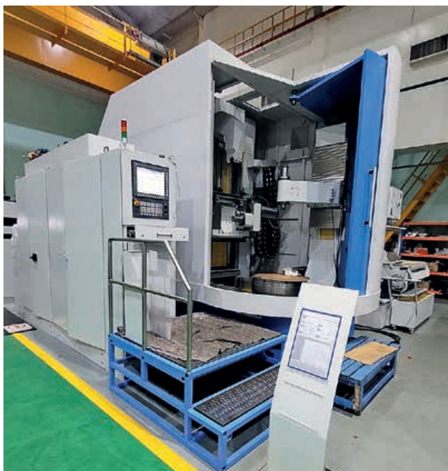
Закуплен зубошлифовальный ЧПУ-станок для шлифовки зубчатых колес, диаметр до 1500 мм, 4-я степень точности, запуск во 2-м кв. 2024 г.
