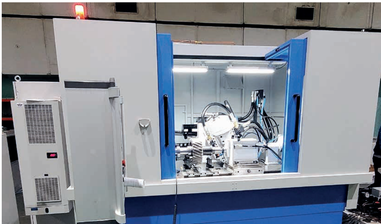
Закуплен зубошлифовальный ЧПУ-станок для шлифовки зубчатых колес, диаметр до 400 мм, 4-я степень точности, запуск во 2-м кв. 2024 г.
