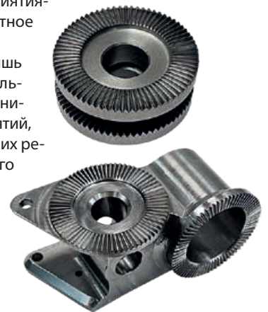
Освоено производство высокоточных зубчатых колес зацепления Хирта
