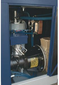
При номинальной производительности компрессора существует возможность подогрева воды до температуры примерно 60°С и выше.
