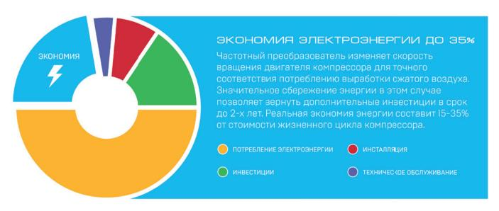
**СИСТЕМА УПРАВЛЕНИЯ** при помощи преобразователя частоты удерживает обороты электродвигателя компрессора на таком уровне, который соответствует реальной потребности в сжатом воздухе. Когда давление в сети падает, преобразователь увеличивает скорость вращения двигателя, что приводит к увеличению производительности компрессора, и наоборот, когда давление растет, – скорость вращения, уменьшается.
